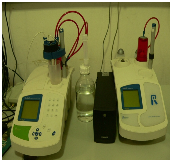
Radiometer (ABU 52-Trilab, TIM 860)
