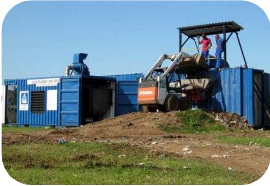
LaDePa (Latrine Dehydration Pasteurisation)
